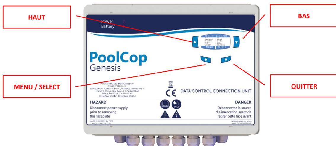
Figure 81 - Clavier et affichage de la DCCU
