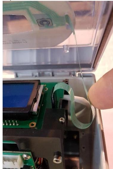
Figure 34 - Guidage de la nappe clavier
