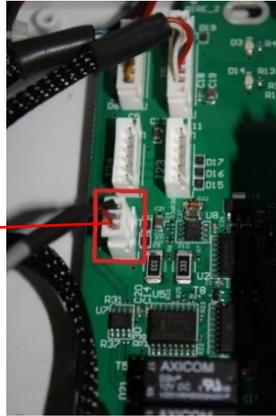
Figure 32 - Capteur de température d'air sur J27
